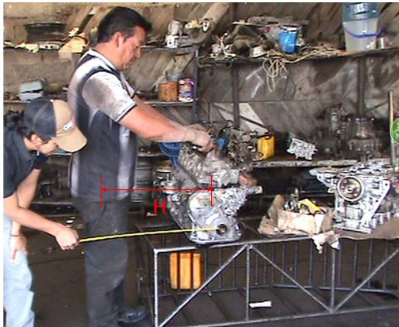
Figura 65. Medición de la distancia horizontal en el destino del montaje
