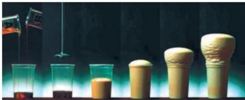
Figura 1. Proceso de espumación del poliuretano
