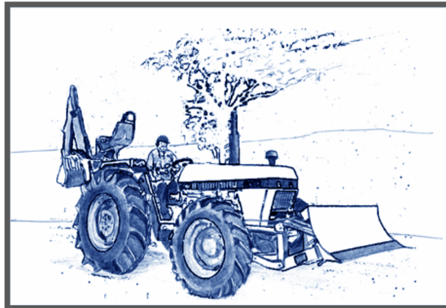
Figura 3: TRACTOR ADAPTADO PARA LAS OPERACIONES DEL RELLENO SANITARIO
