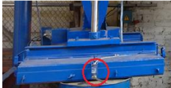
Figura III-81. Final de Carrera Inferior Molde Fuente.- Los Autores
