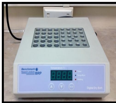
FOTOGRAFÍA No.6 TERMOBLOCK, ÁREA DE MICROBIOLOGÍA DEPARTAMENTO DE CONTROL DE CALIDAD GINSBERG ECUADOR S.A. QUITO. FEBRERO DEL 2014.
