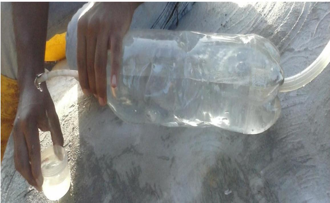
**ANEXO 11. COLOCACIÓN DE FILTRO DE LIMALLAS DE HIERRO Y MANGUERA PARA CIRCULACIÓN DE BIOGAS.**
