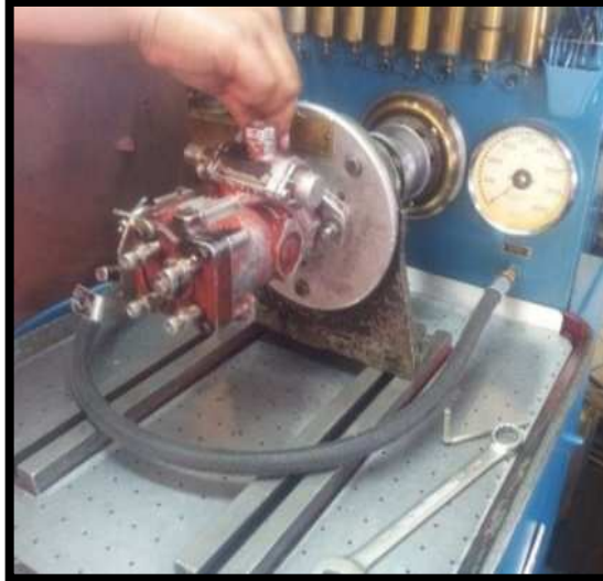
Figura 104. Acoplamiento de la bomba de combustible
