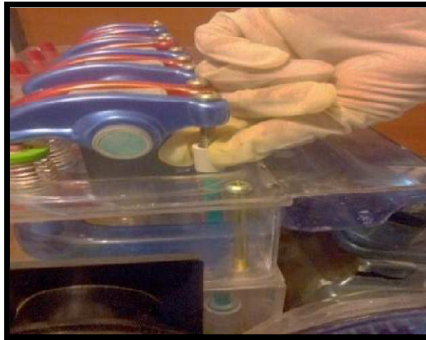
Figura 86. Ajuste de balancines
