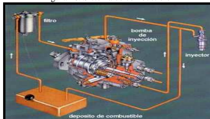
Figura 16. Sistema de combustible
