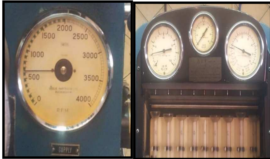
Figura 108. Caudal de combustible
