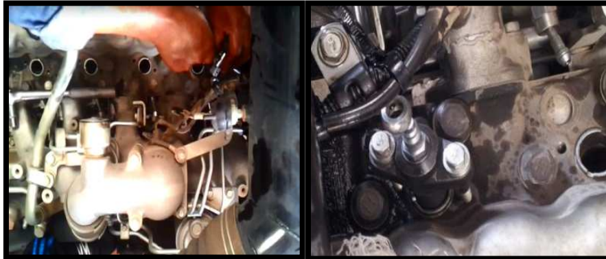
Figura 99. Colocación del inyector en el cilindro
