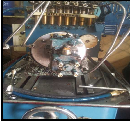
Figura 110. Desacoplamiento de la bomba de combustible
