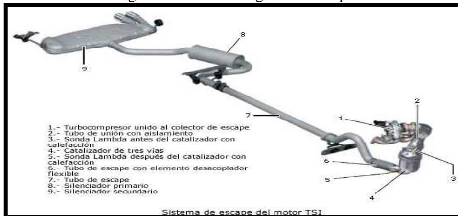
Figura 18. Sistema de gases de escape
