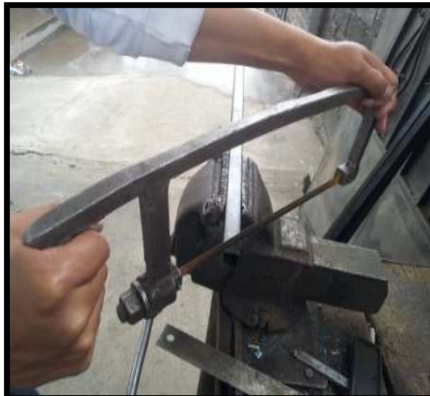
Figura 63. Corte del tubo
