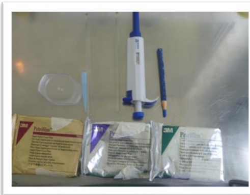
FOTOGRAFÍA NO. 27 PETRIFILM PARA LA EJECUCIÓN DE ENSAYOS EN EL ÁREA MICROBIOLÓGICA DEL LABORATORIO DE ALIMENTOS MOCEPROSA S.A
