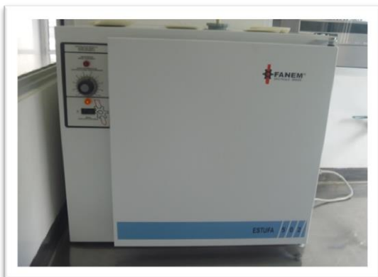
FOTOGRAFÍA NO. 20 ESTUFA FANEM 502 UTILIZADA PARA LA INCUBACIÓN DE LOS MICROORGANISMOS
