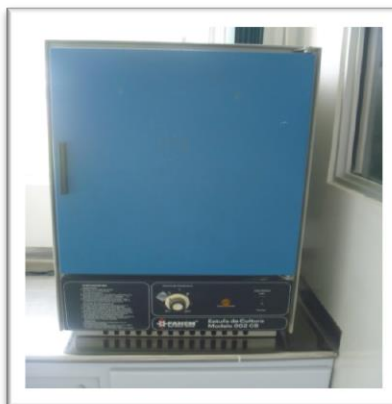
FOTOGRAFÍA NO. 21 ESTUFA DE CULTURA FANEM 002C UTILIZADA PARA LA INCUBACIÓN DE LOS MICROORGANISMOS
