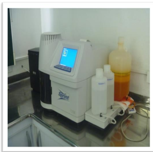
FOTOGRAFÍA NO. 5 EQUIPO PARA LA REALIZACIÓN DEL ENSAYO DE PROTEÍNA DEL LABORATORIO DE ALIMENTOS MOCEPROSA S.A.
