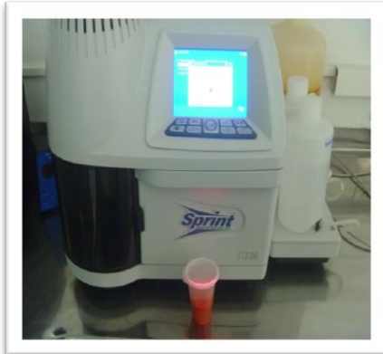
FOTOGRAFÍA NO. 9 EJECUCIÓN DEL ENSAYO DE PROTEÍNA DEL LABORATORIO DE ALIMENTOS MOCEPROSA S.A.
