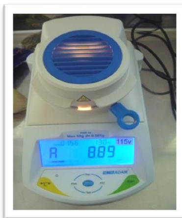
FOTOGRAFÍA NO. 4 EQUIPO PARA LA REALIZACIÓN DEL ENSAYO DE HUMEDAD DEL LABORATORIO DE ALIMENTOS MOCEPROSA S.A.
