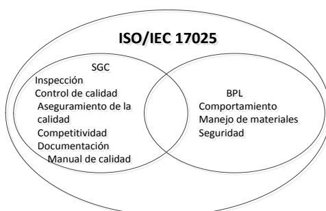
Figura No. 4 Diagrama de Relación entre BPL, SGC y la Norma NTE-ISO/IEC 17025:2005
