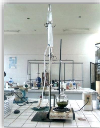
FOTOGRAFÍA #3EQUIPO DE OBTENCIÓN Y CUANTIFICACIÓN DE ACEITES ESENCIALES.
