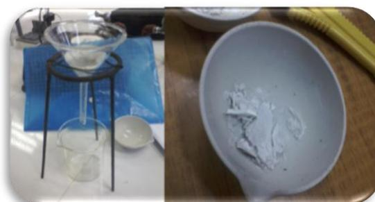
**FOTOGRAFÍA No. 9 DETERMINACIÓN DE CENIZAS INSOLUBLES EN HCl**
