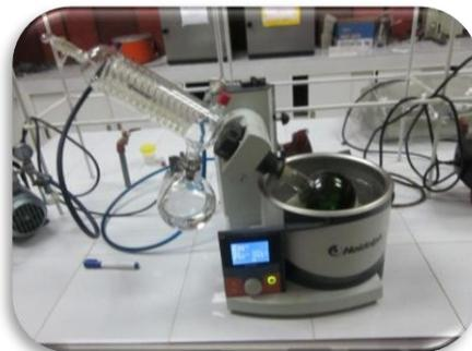
**FOTOGRAFÍA No. 4 EVAPORACIÓN DEL SOLVENTE ETANÓLICO**
