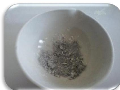
**FOTOGRAFÍA No. 7 DETERMINACIÓN DE CENIZAS TOTALES**
