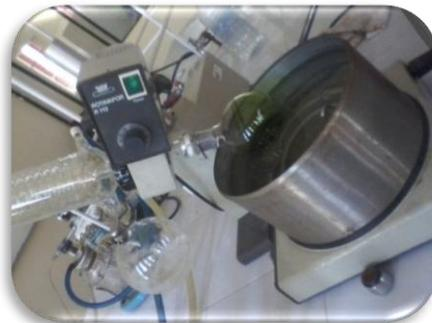
**FOTOGRAFÍA No. 3 EVAPORACIÓN DEL SOLVENTE ETÉREO**
