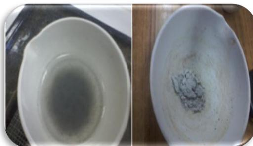
**FOTOGRAFÍA No. 8 DETERMINACIÓN DE CENIZAS SOLUBLES EN H<sub>2</sub>O**
