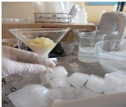
**FILTRACIÓN DEL EXTRACTO ENZIMÁTICO**
