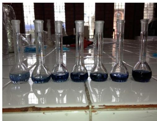
**PATRÓN DE ÁCIDO GÁLICO PARA LA CURVA DE CALIBRACIÓN**
