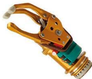
Figura II.8 Mano eléctrica MyoHand de la empresa Otto Bock
