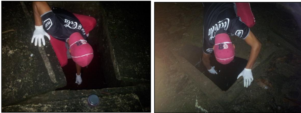
Toma de muestras de Agua en la Entrada y Salida del Digestor
