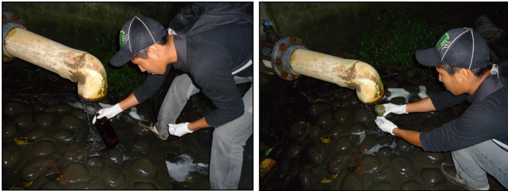
Toma de muestras de Agua en la Descarga
