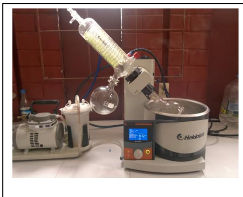
FOTOGRAFIA No6. CONCENTRACIÓN DEL AGUAMIEL
