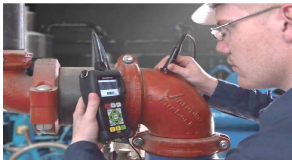
Figura 5. Inspección por ultrasonido
