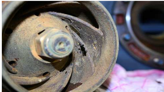
Figura 25. Modo de falla por cavitación del alabe de una bomba
