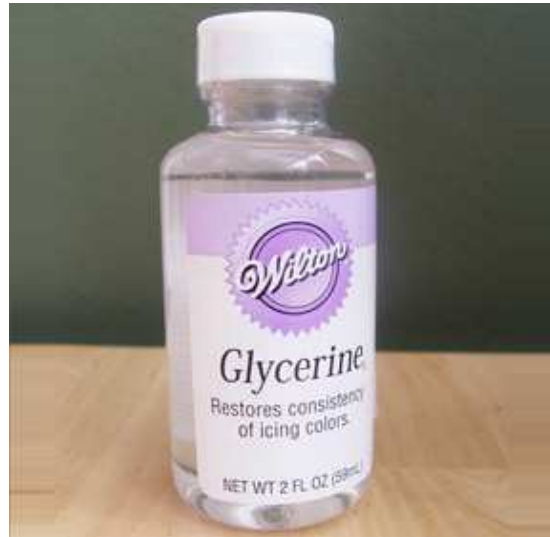
Figura 45. Acoplante utilizado en inspección
