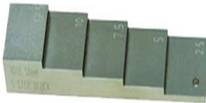
Figura 44. Bloque de calibración de cinco espesores
