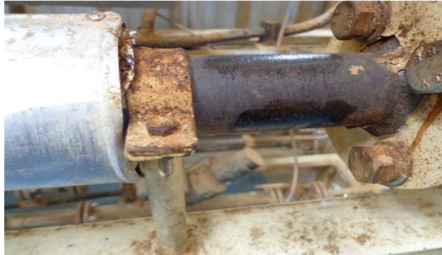
Figura 65. Aplicación de glicerina sobre la superficie
