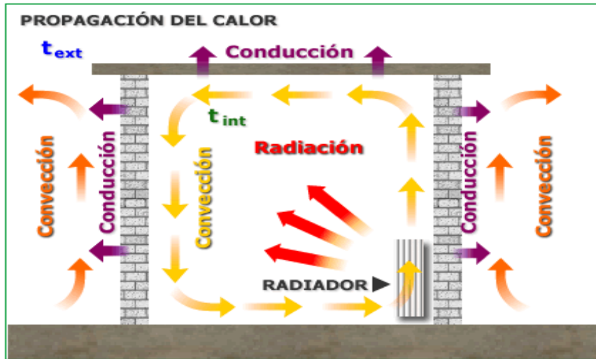
Figura 4. Esquema de los mecanismos de transferencia de calor
