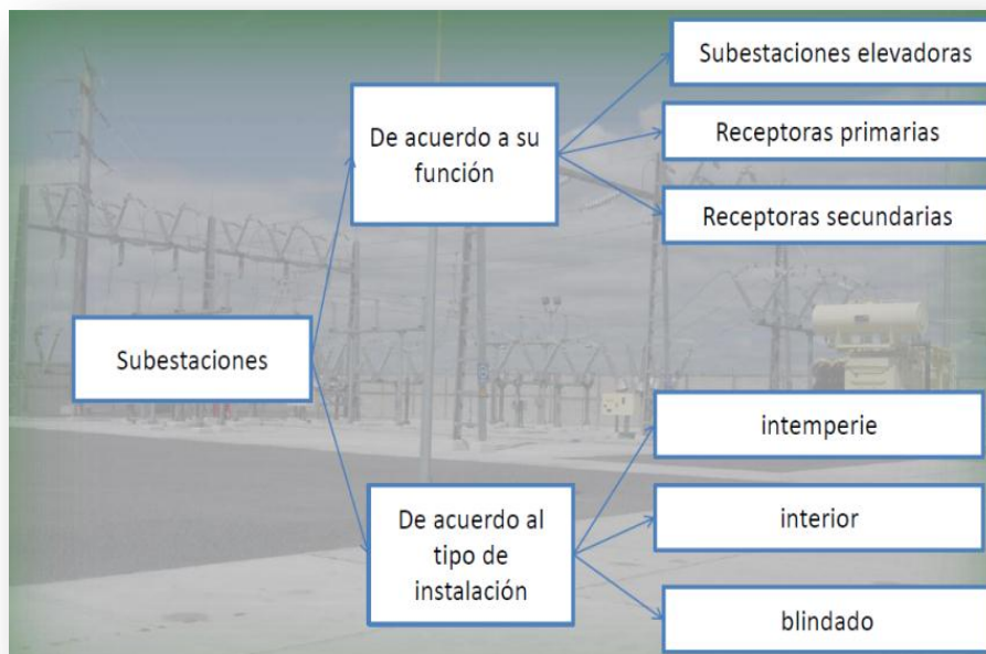
Figura 8. Clasificación de las subestaciones
