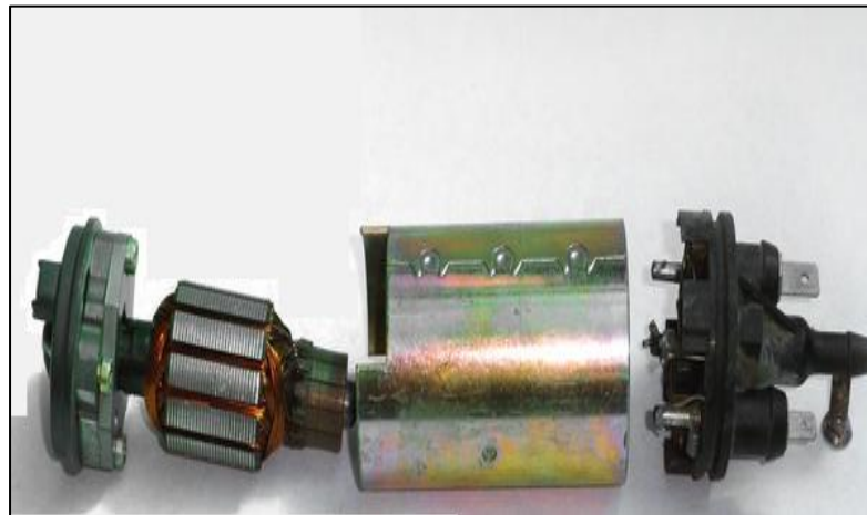
Figura 57. Bomba eléctrica de combustible
