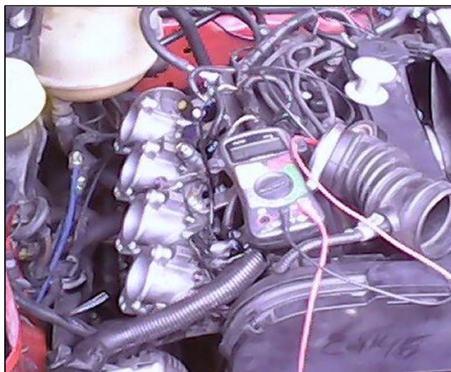
Figura 64. Implementación de la admisión ITB en el vehículo
