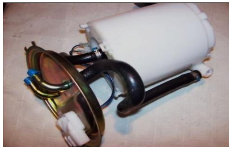
Figura 75. Bomba de combustible en el vehículo
