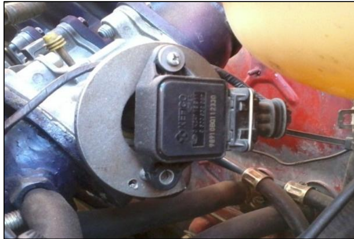
Figura 72. Ubicación del sensor TPS en el vehículo
