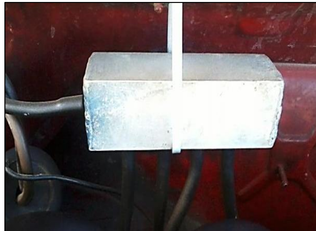
Figura 74. Caja recuperadora de vacío para el sensor MAP
