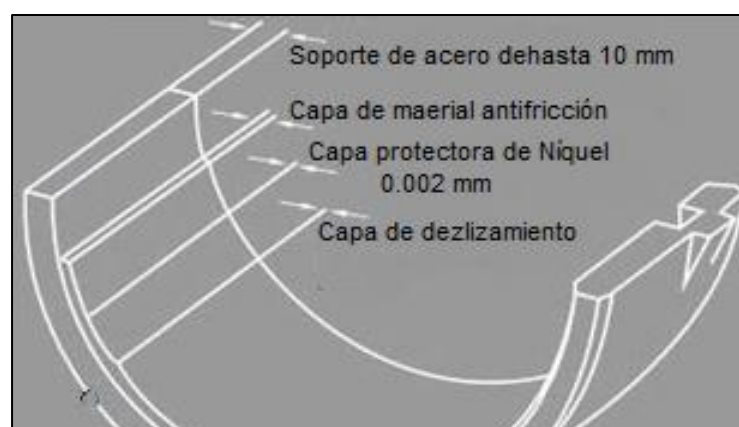
Figura 11. Materiales que forman parte de un cojinete
