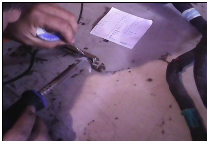
Figura 76. Conexión de los conectores de la MegaSquirt
