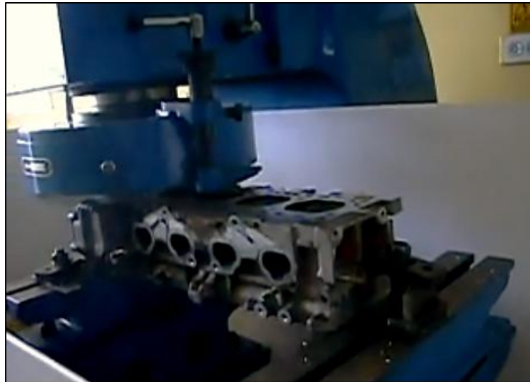
Figura 62. Fresado de una culata para aumentar la relación de compresión
