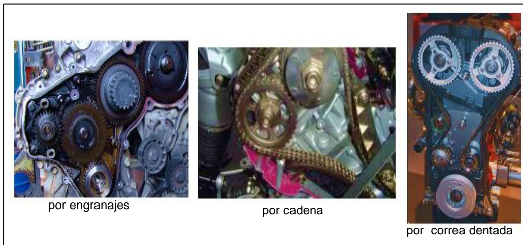
Figura 19. Formas de accionamiento del árbol de levas
