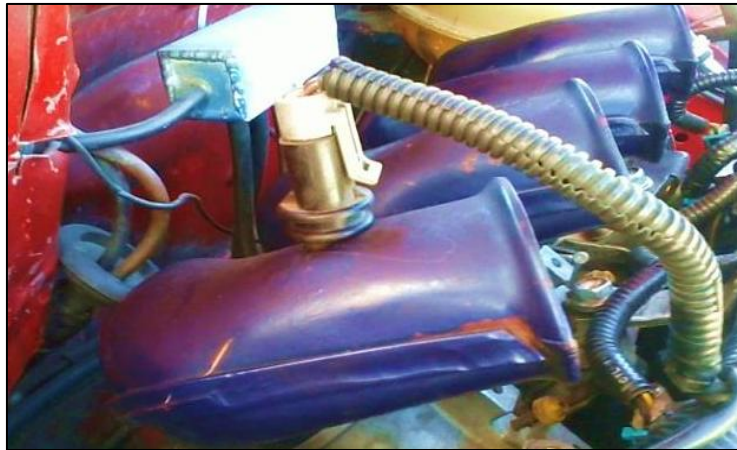
Figura 70. Ubicación del sensor IAT en el vehículo
