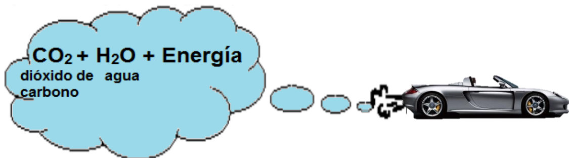
Figura 7. Productos de la combustión de vehículos a Gas Licuado de Petróleo
