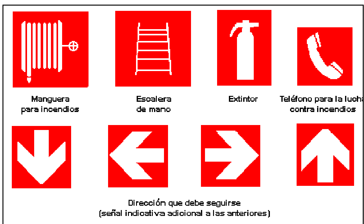
Gráfico 11. Señales de equipos de lucha contra incendios.
