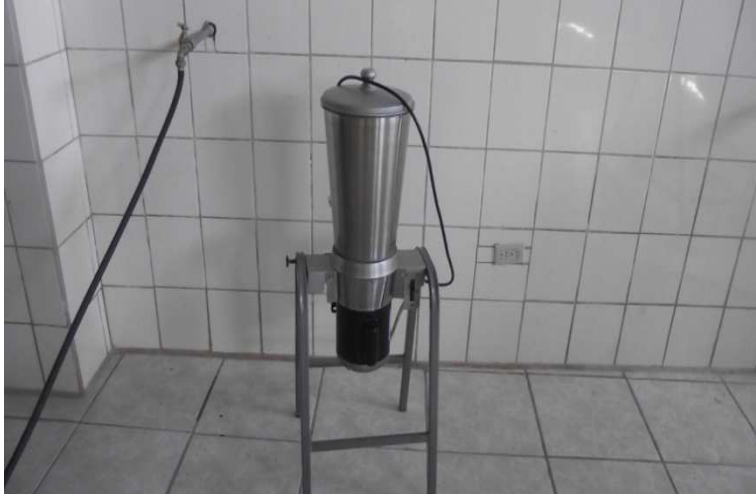
Pie de foto: Se muestra la licuadora industrial dentro de la planta.
