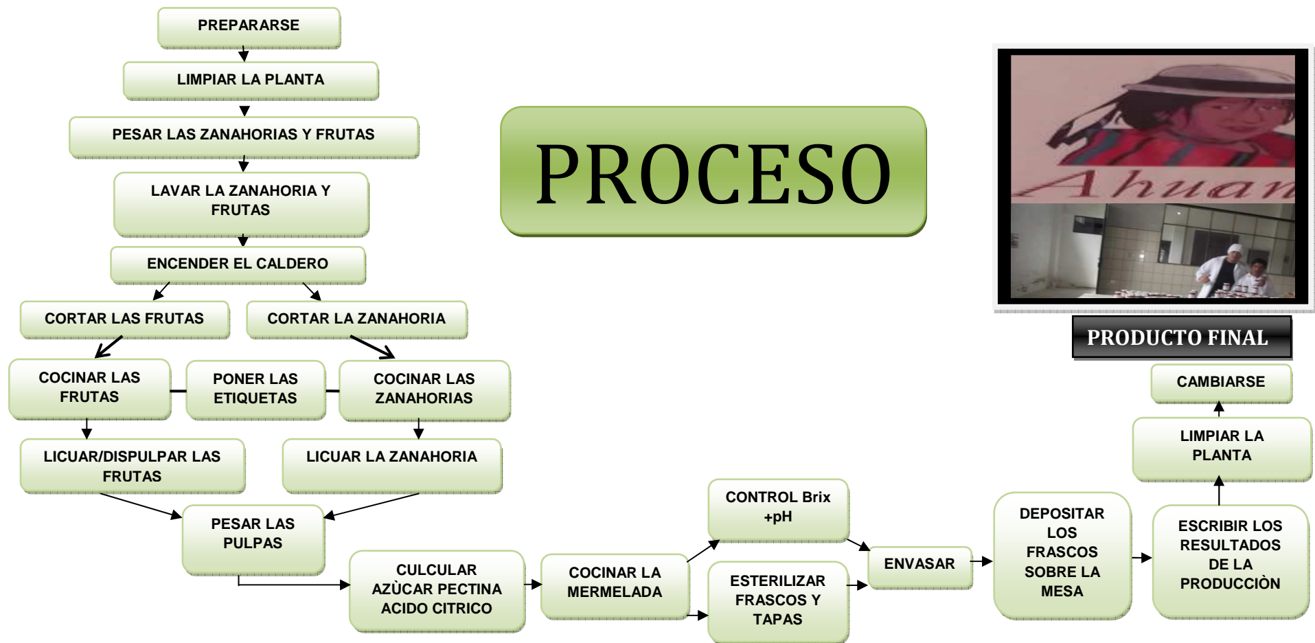
FIGURANº2 FLUJOGRAMA ACTUAL DEL PROCESO DE PRODUCCIÓN DE LA MERMELADA
