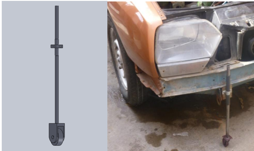
Figura59. Mecanismo para prueba de cabeceo (Eje desplazable)
