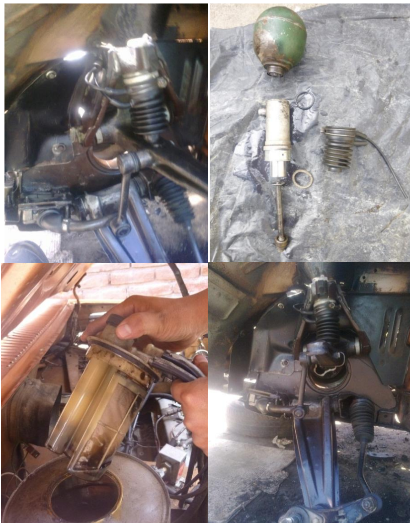
Figura 40. Desensamble del sistema hidroneumático
