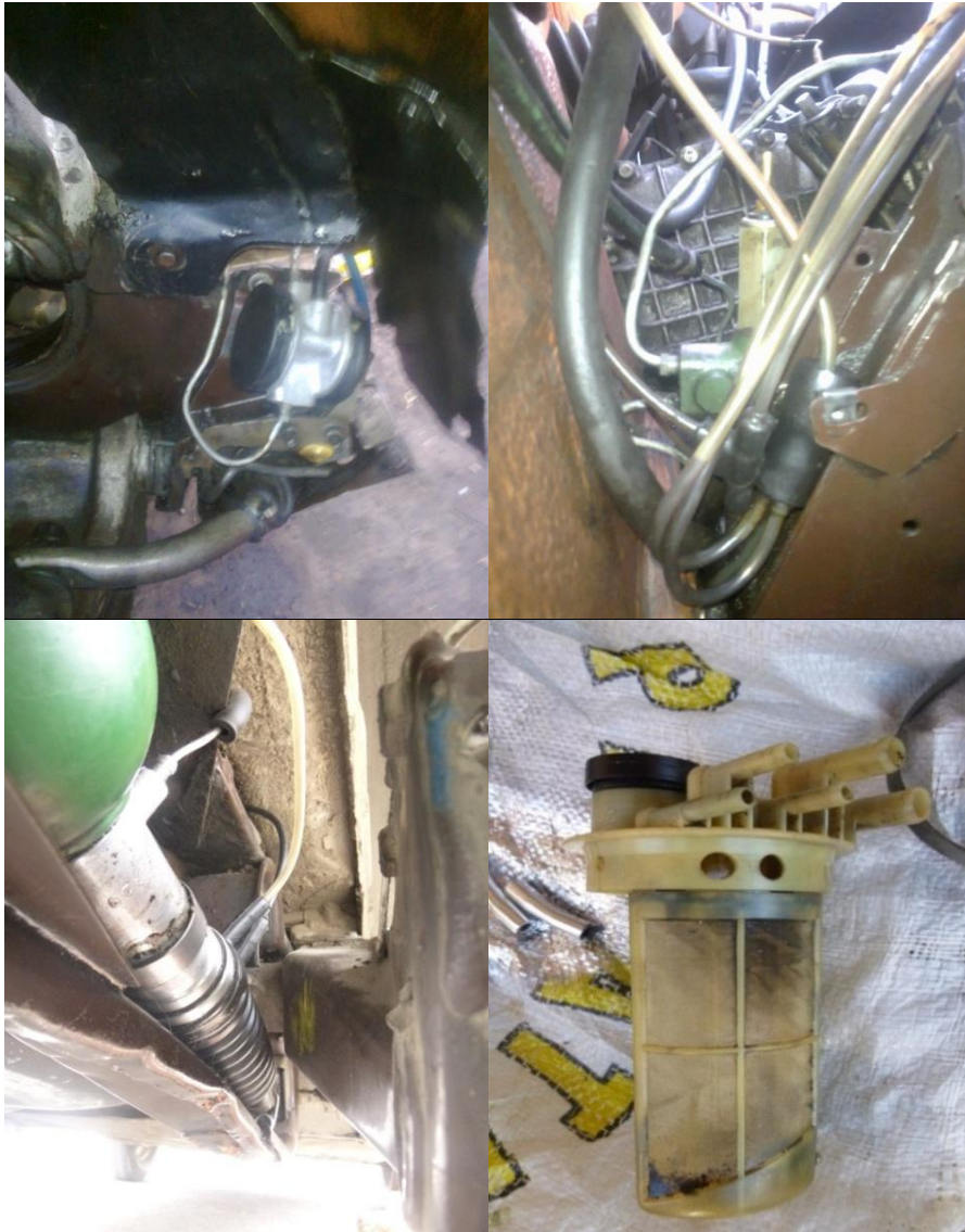
Figura 41. Reparación, limpieza y ensamblaje del sistema hidroneumático
