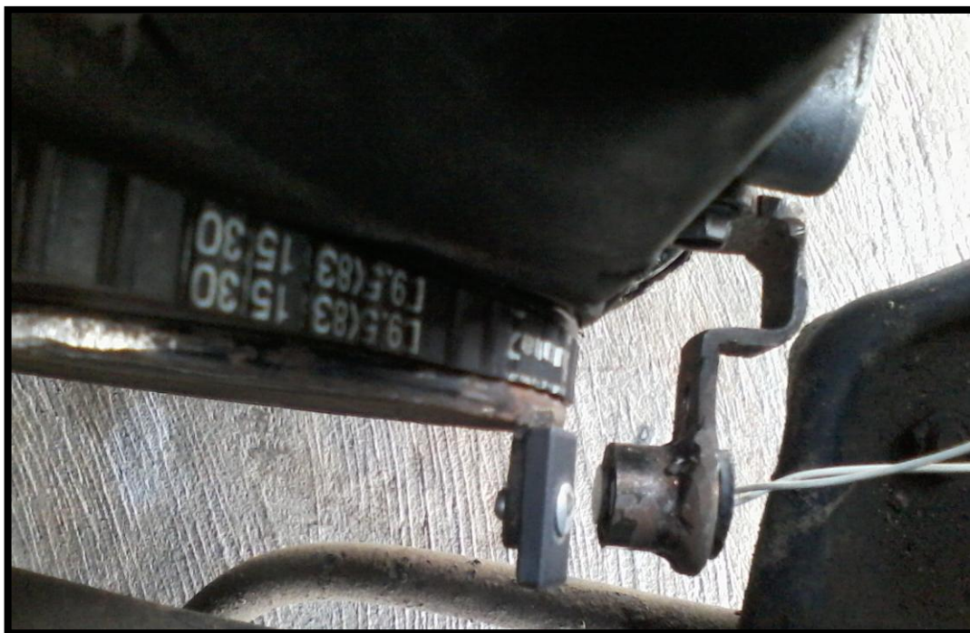
Figura 56. Ubicación del sensor para medir revoluciones
