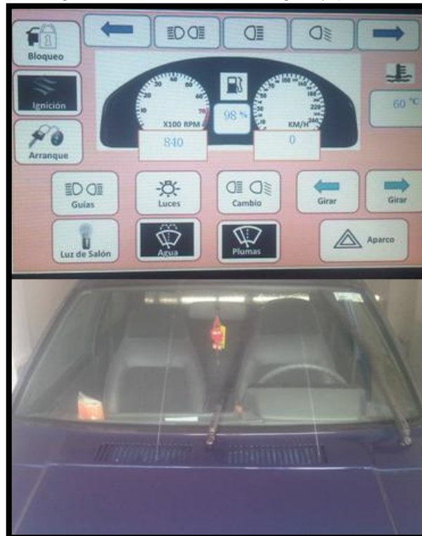
Figura 68. Activación de agua y plumas
