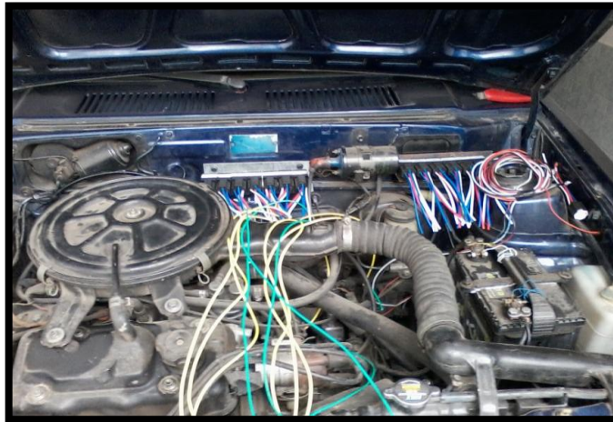
Figura 52. Cableado exterior del habitáculo
