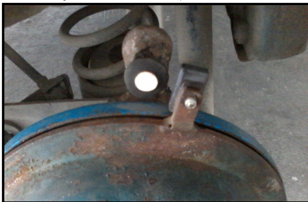
Figura 57. Ubicación del sensor para medir velocidad
