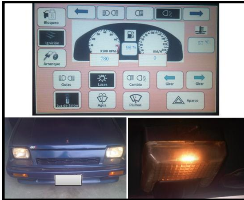
Figura 67. Activación de luz de salón y luces faros
