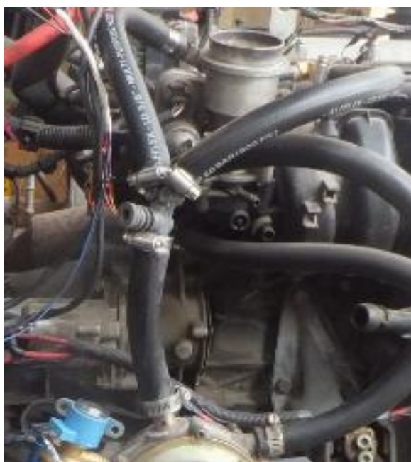
Figura 69. Instalación del regulador del caudal de máxima
