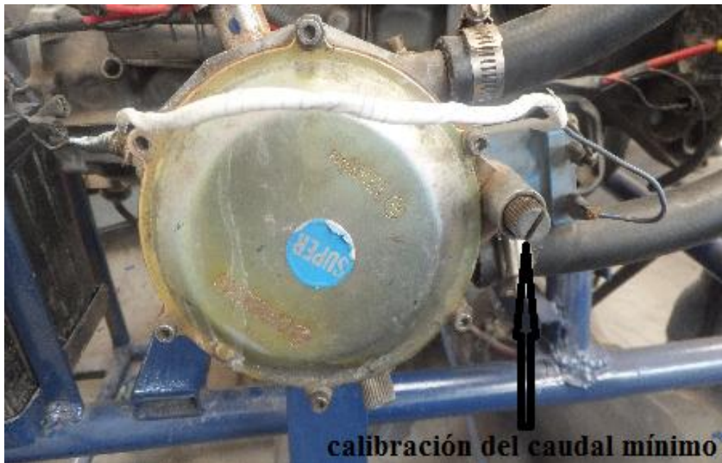
Figura 71. Calibración del caudal mínimo
