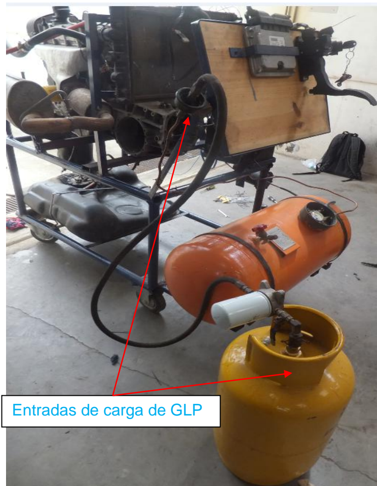
Figura 82. Carga del depósito de GLP
