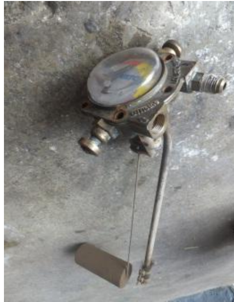
Figura 57. Multivalvula para colocar en el tanque
