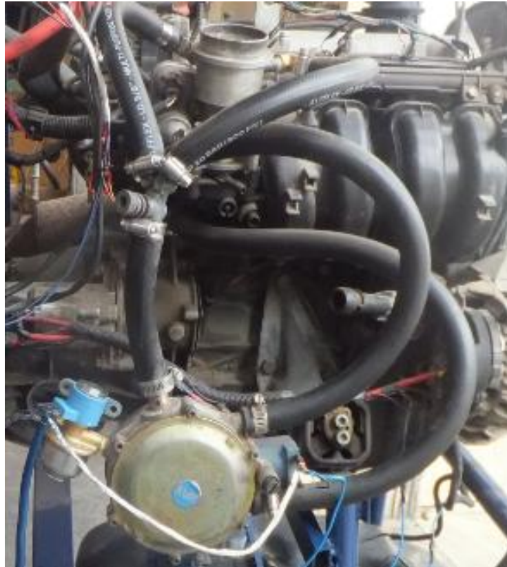
Figura 66. Instalación del evaporador
