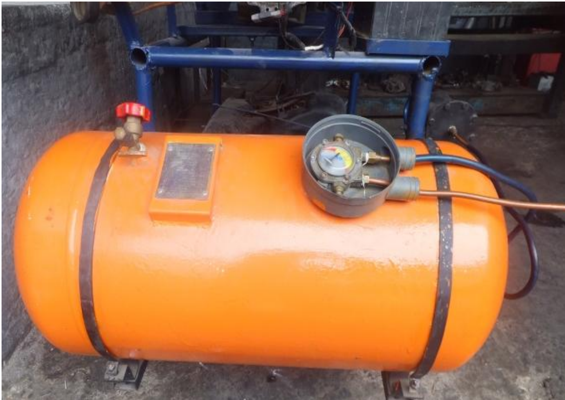
Figura 61. Instalación del tanque de almacenamiento
