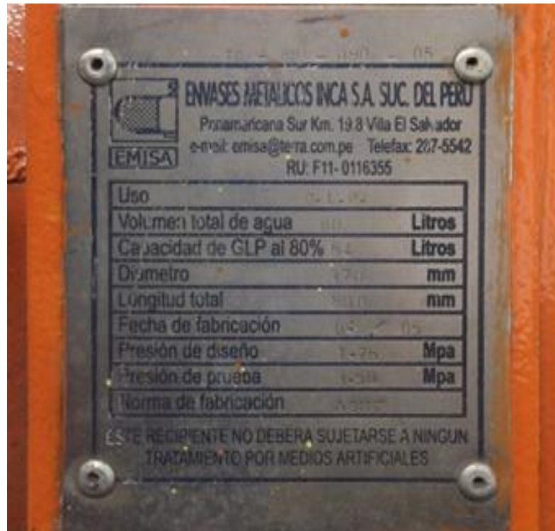
Figura 27. Placa de información del tanque
