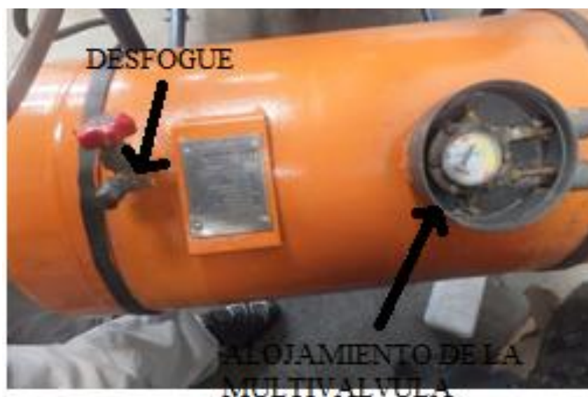
Figura 56. Alojamiento de la multiválvulas y desfogue
