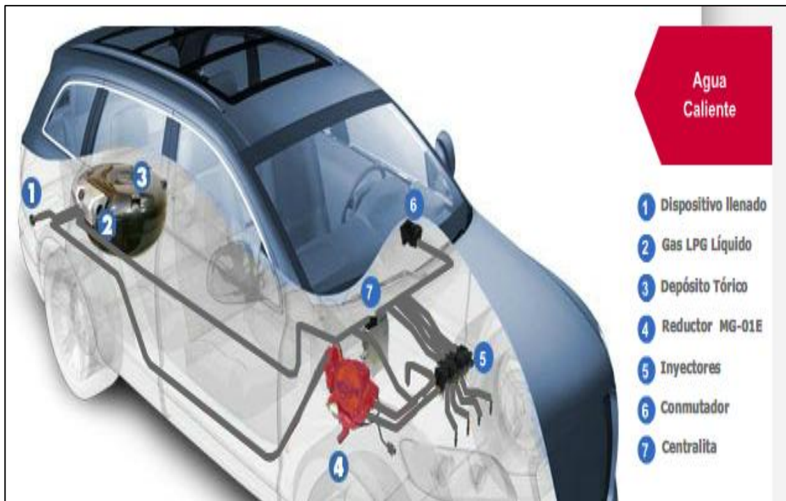
Figura 53. Paso de fase líquida a fase gaseosa del GLP en el evaporador o regulador de presión
