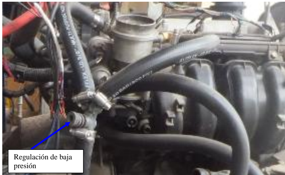
Figura 72. Instalación del circuito de baja presión
