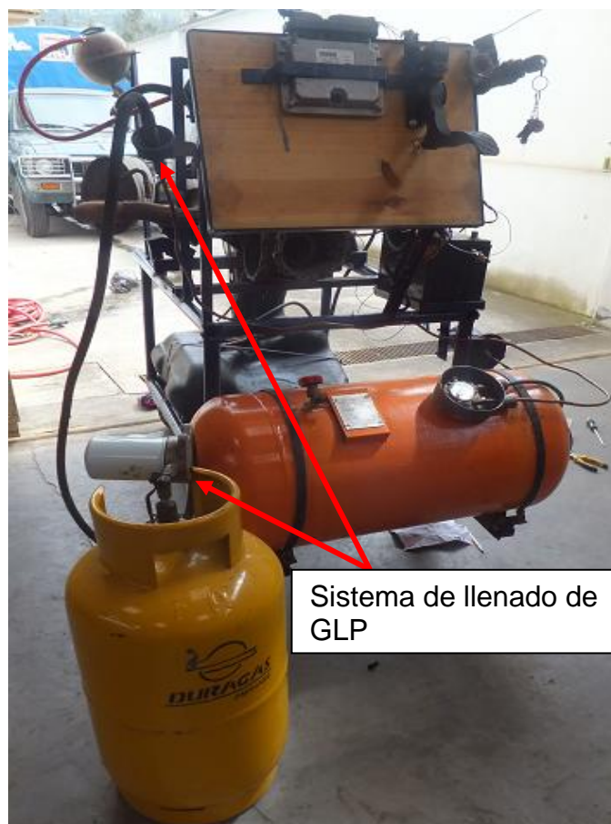
Figura 89. Llenado del sistema de GLP
