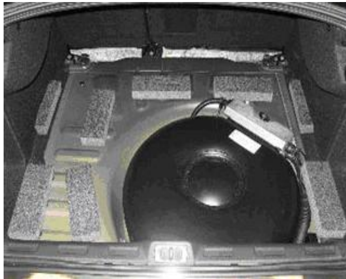
Figura 23. Depósito toroidal interno
