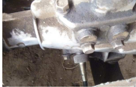
Figura 76. Cable del velocímetro donde se conecta la rueda dentada
