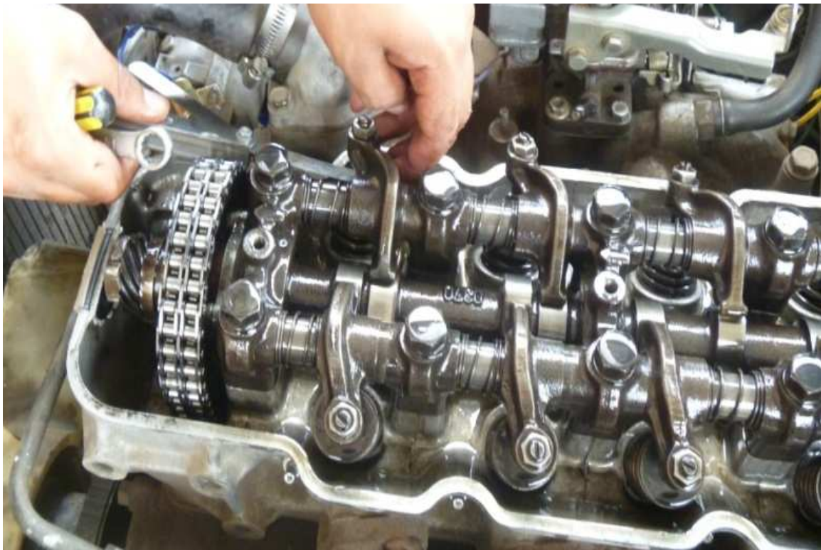
Figura 83. Calibración de válvulas
