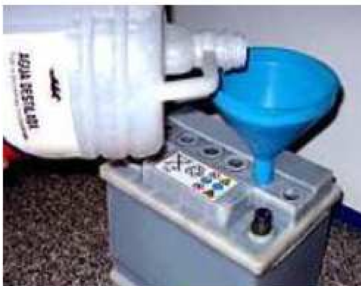
Figura 94. Llenado del electrolito de la batería
