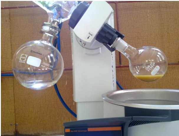
FOTOGRAFIA N° 18 CONCENTRAR LOS EXTRACTOS EN EL ROTAVAPOR (Heidolph).
