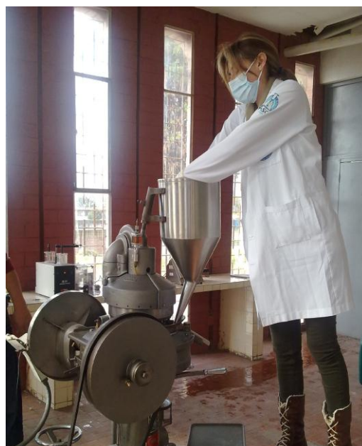
FOTOGRAFIA N° 22 TABLETEADO DEL GRANULADO.
