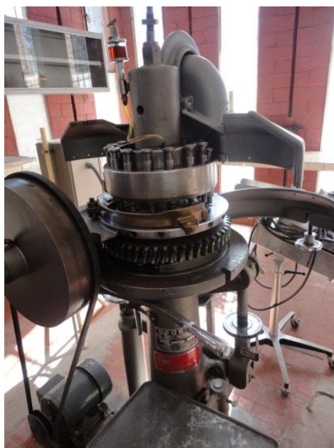
FOTOGRAFIA N° 22 TABLETEADO DEL GRANULADO.
