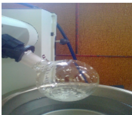
FOTOGRAFÍA No. 2 Extracción del cloroformo en el rotavapor.
