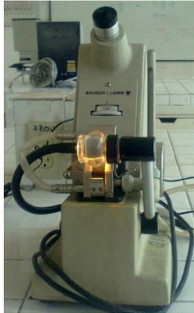
FOTOGRAFÍA N°7 Refractómetro
