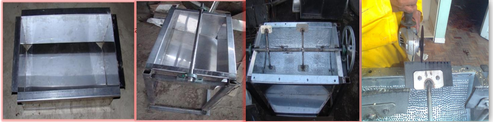
Construcción de la cámara de descascarillado.
