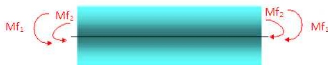
Figura 28. Elemento sometido a flexión compuesta
