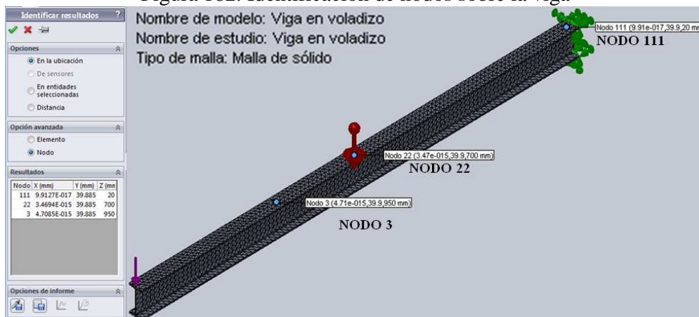
Figura 182. Identificación de nodos sobre la viga
