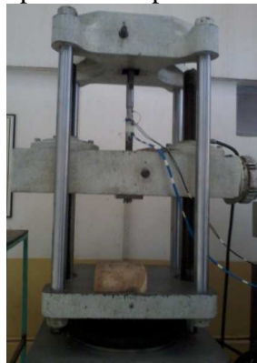
Figura 104. Probeta utilizada para la comprobación del puente de Wheatstone
