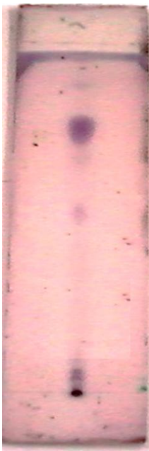
FOTOGRAFÍA 3: TLC PARA SAPONINAS HIDROLIZADAS, SISTEMA DE SOLVENTES ÉTER- HEXANO- ACETATO DE ETILO (1:1:1) V/V REVELADOR VAINILLINA ÁCIDO SULFÚRICO. FACULTAD DE CIENCIAS. ESPOCH. JULIO 2012
