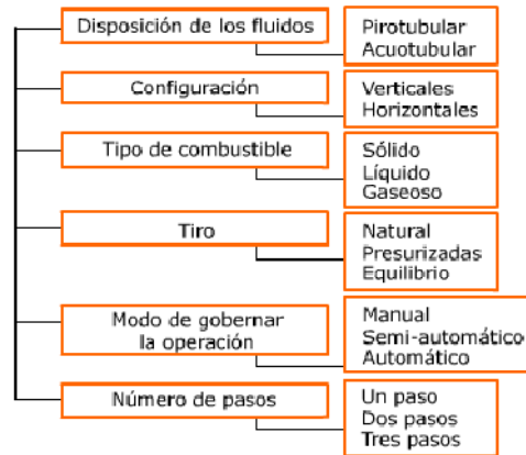
Figura 2. Clasificación de las calderas
