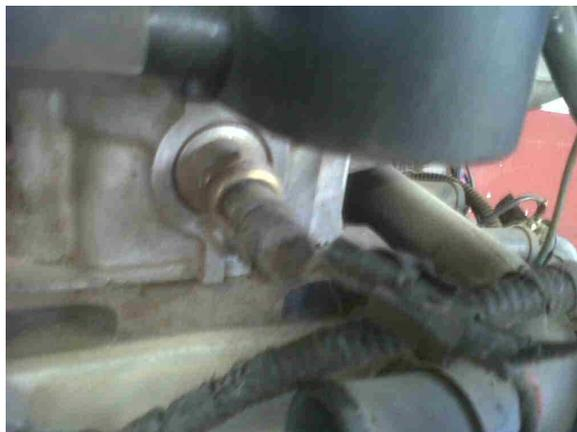
Es un termistor NTC o termistor de coeficiente negativo el cual a mayor temperatura tiene menor voltaje. O puede ser un Termistor PTC termistor de coeficiente positivo el cual a mayor temperatura mayor resistencia.
