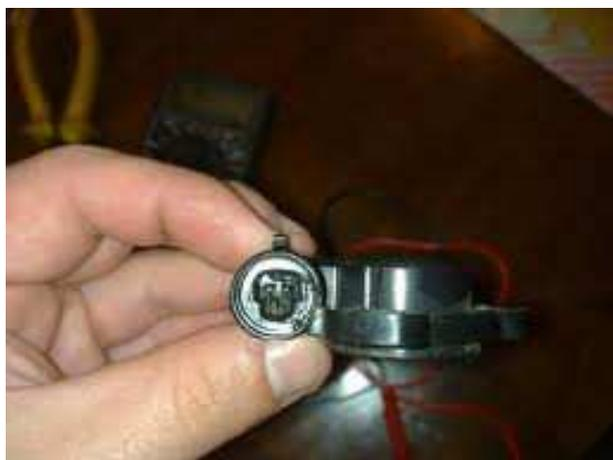
La señal del TPS es del tipo analógica y la señal del Idle Switch es de tipo todo o nada (OFF-ON).
