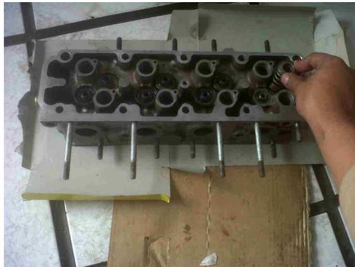
5. Colocamos los resortes de válvulas, utilizando una herramienta adecuada.
