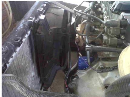
3. Colocamos el termoswitch y el sensor de temperatura.
