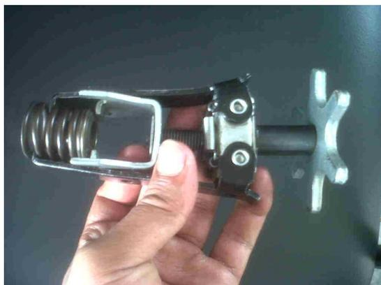
6. Una vez comprimido los resortes colocamos sobre el vástago de las válvulas y antes de ser aflojado el compresor de resortes colocamos los seguros.
