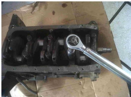
5. Utilizando un martillo de suela o de plástico, bata levemente en el cigüeñal, en los dos sentidos, con el objeto de asentar, principalmente, la cara posterior del cojinete de apoyo.
