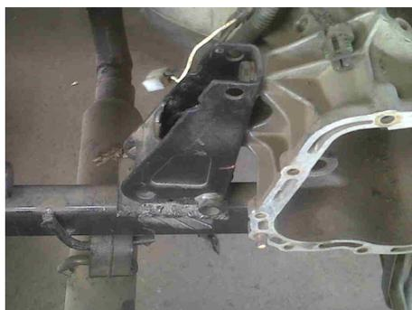
La tercera base está ubicada en la parte intermedia izquierda del motor (en la parte inferior del para llama).
