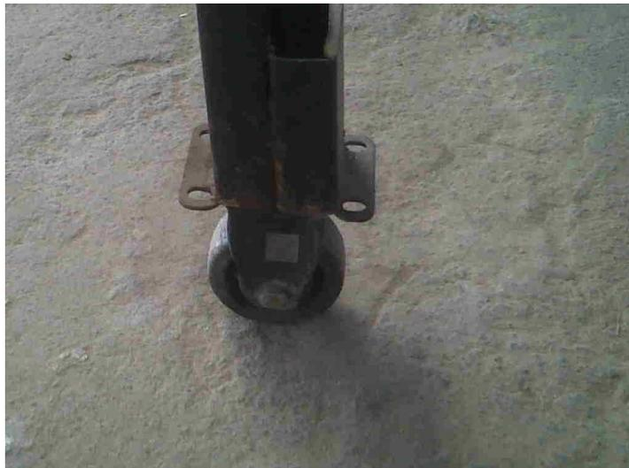
**Soporte.** Se coloca una varilla  $\frac{1}{2}$ " de acero entre el ángulo formado por cada larguero y travesaño, para evitar deformaciones.
