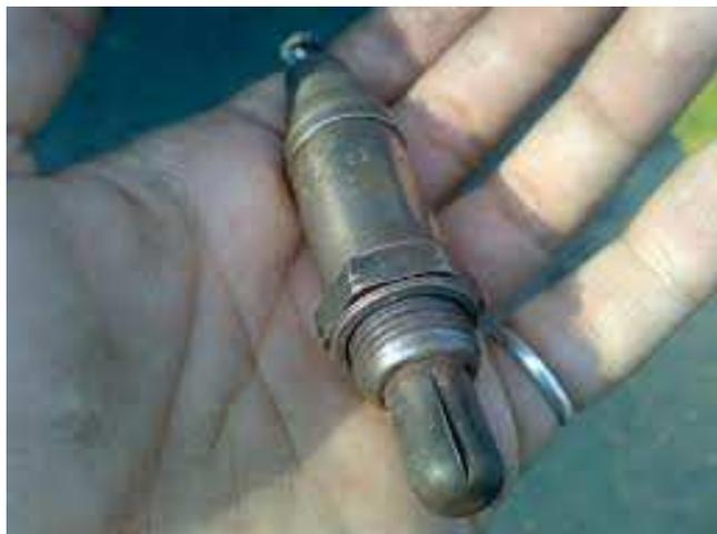
**Sonda lambda de1 cable sin calefactor.** Por lo general este tipo de sonda está muy cerca de la salida de gases, lo que permite que la misma trabaje a alta temperatura.
