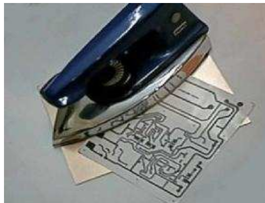
Figura 23. Transferencia térmica del papel hacia la lámina de cobre
