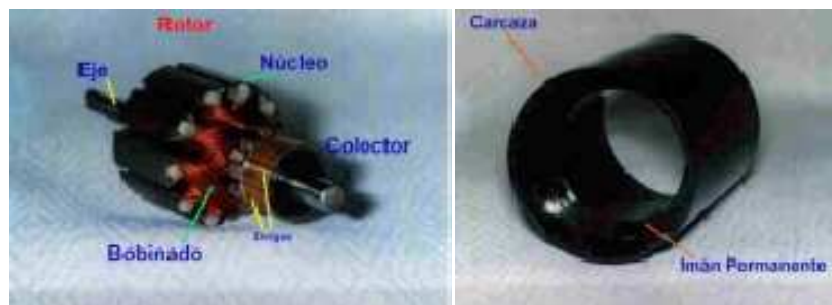
Figura 4. Partes del motor de corriente directa
