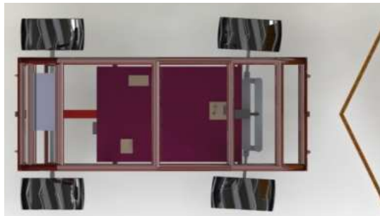
Figura 28. Ubicación del sensor a 15cm desde el borde del filo
