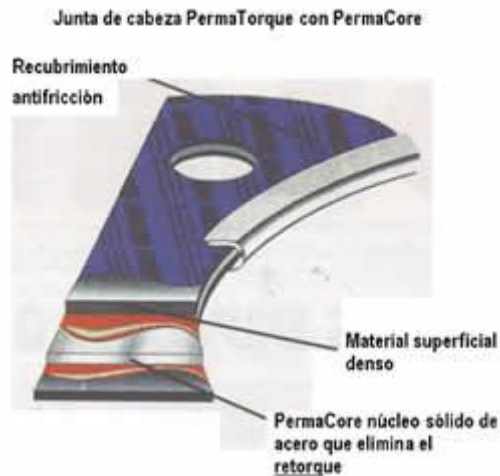
Figura 43. Constitución interna del empaque.
