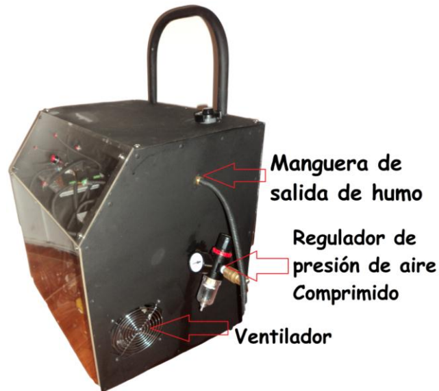
Figura 69. Distribución lateral del detector de fugas.
