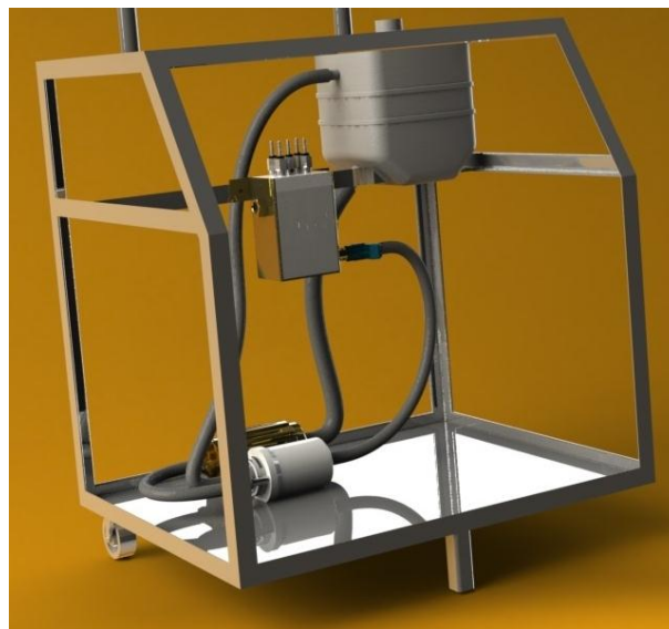
Figura 66. Instalación de sistema de alimentación de aceite.
