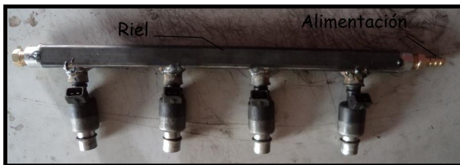
Figura 57. Riel de inyectores.
