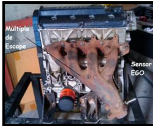
Figura 63. Múltiple de escape con sensor EGO instalado.
