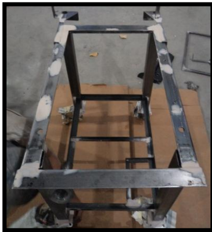
Figura 43. Masillado del banco de pruebas.
