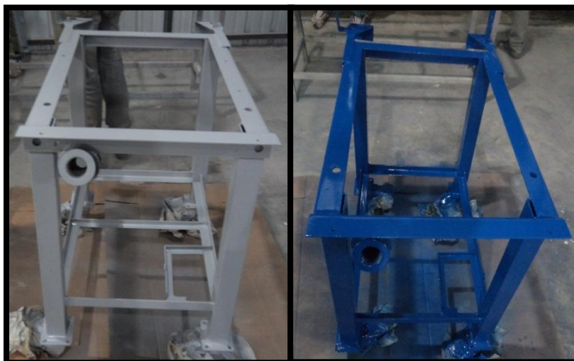
Figura 44. Proceso de pintura del banco de pruebas.
