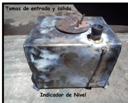
Figura 50: Tanque de Combustible.
