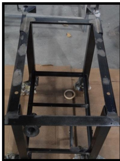
Figura 42. Aplicación de capa base (adherente).
