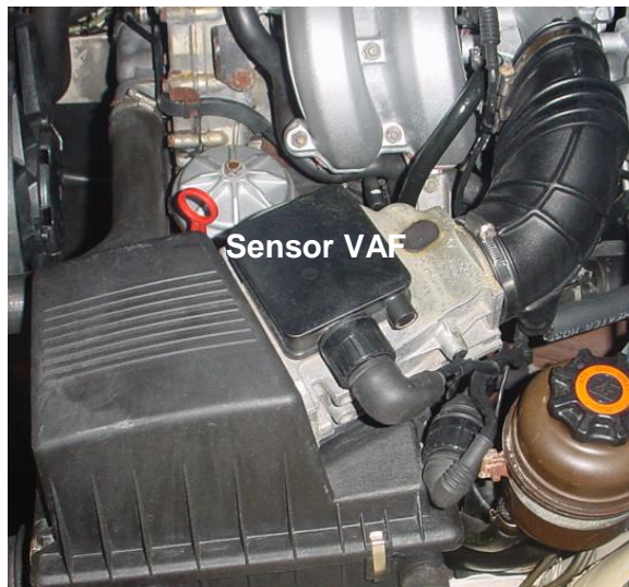
Figura 58. Ubicación del sensor VAF
