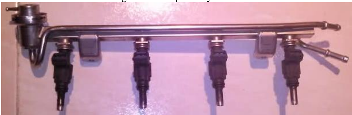
Figura 12. Rampa de inyectoros
