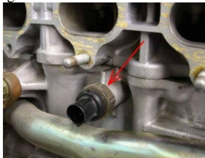
Figura 79. Ubicación del sensor KS
