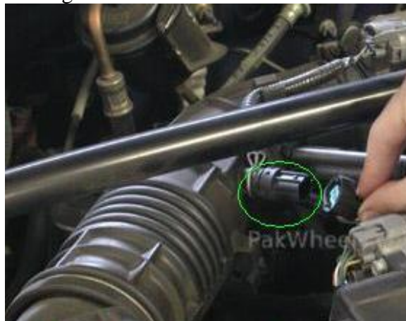
Figura 62. Ubicación del sensor IAT
