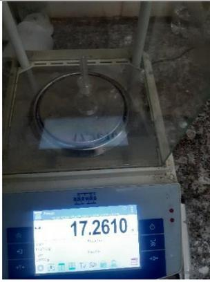
**Calibración y pesaje del picnómetro**
