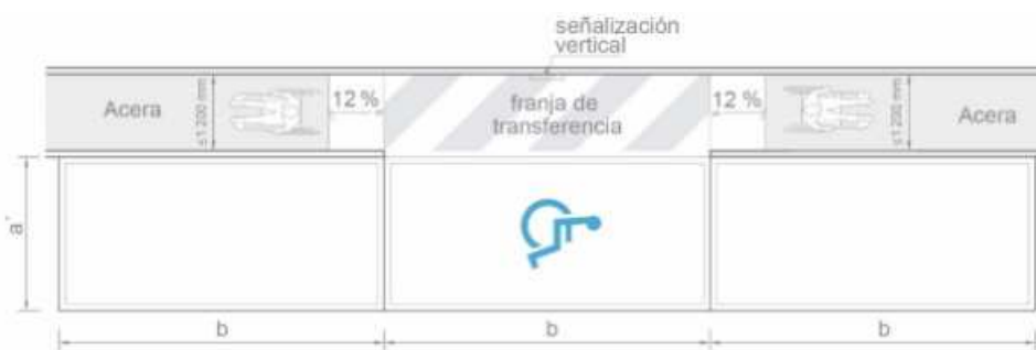
Ilustración 14-2: Altura de la acera se ha reducido al nivel de la calle.
