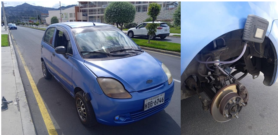
Ilustración 5-3: Equipamiento del tren de muestreo Criffer en el vehículo tipo Hatchback.
