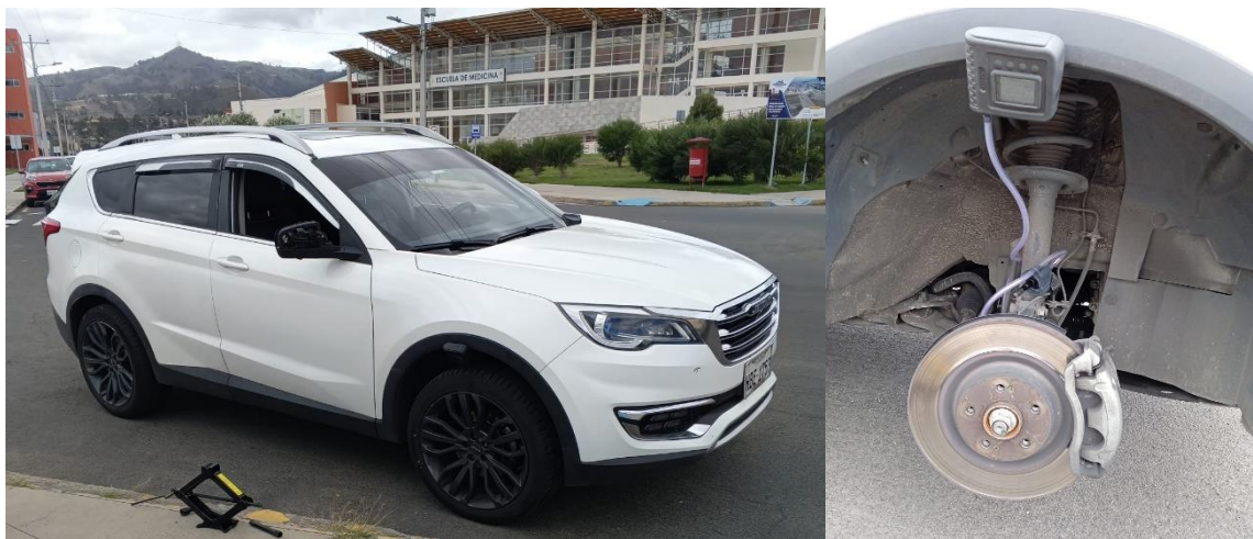
Ilustración 4-3: Equipamiento del tren de muestreo Criffer en el vehículo tipo SUV.
