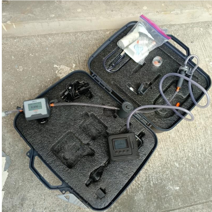
Ilustración 3-3: Equipo de muestreo marca Criffer modelo Accura 3 Plus.
