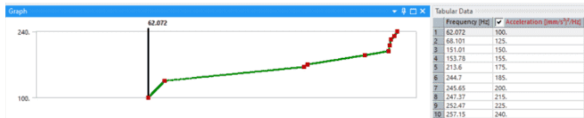
Ilustración 4-17: Datos de frecuencia y aceleración ingresados en ANSYS para la simulación en el nuevo diseño
