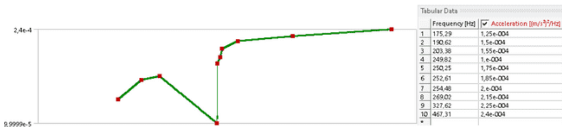
Ilustración 4-28: Datos de frecuencia y aceleración ingresados en ANSYS para la simulación.
