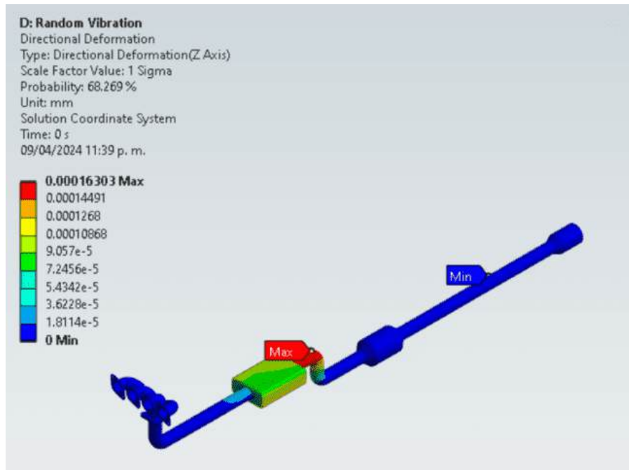
Ilustración 4-7: Deformación direccional en base a las variables de frecuencia y aceleración
