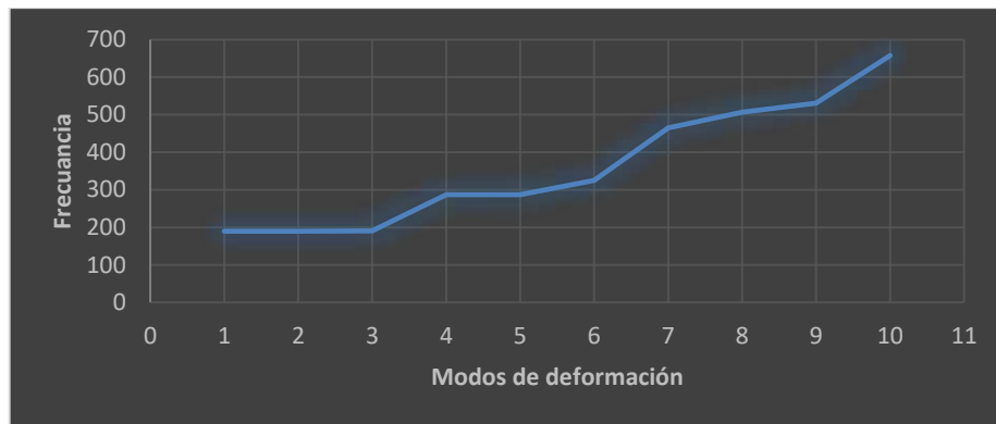
Ilustración 4-3: Modos de deformación a medida de aumento de frecuencia
