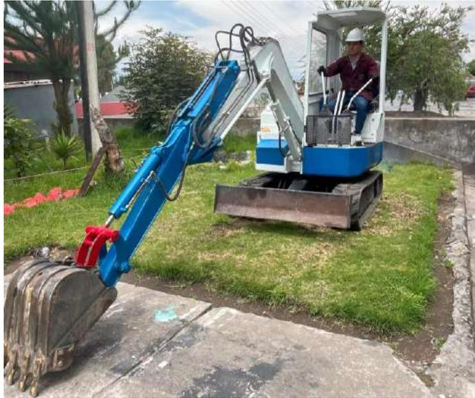
**Ilustración 3-24:** Brazo en posición de descanso.
