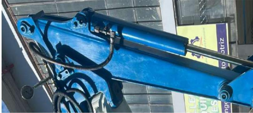
**Ilustración 3-10:** Brazo de excavación o pluma.
