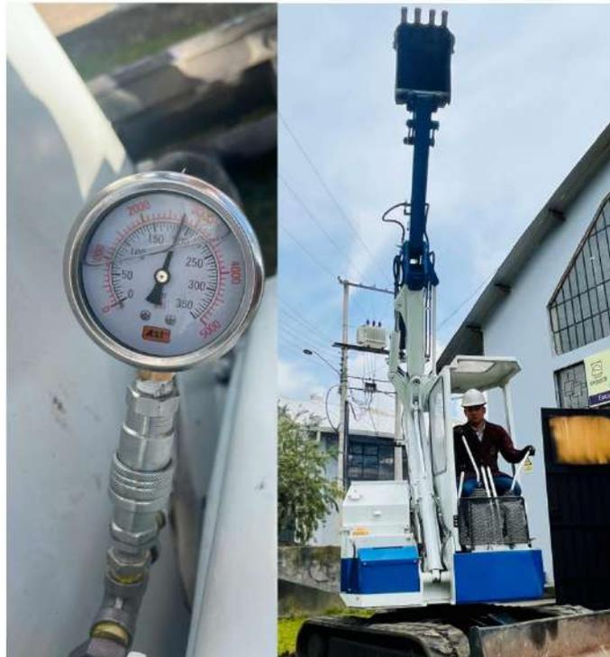
**Ilustración 4-3:** Presión cilindro de elevación completa.
