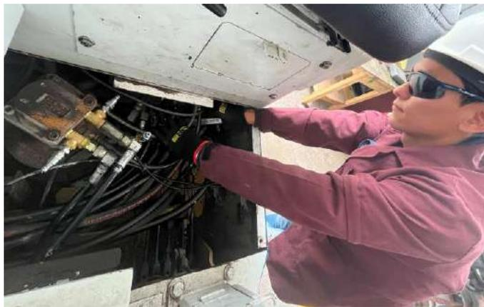
**Ilustración 3-21:** Válvulas de control.
