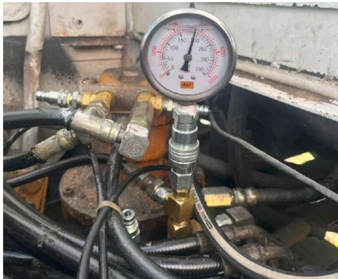
**Ilustración 4-1:** Presión de trabajo válvula de control.
