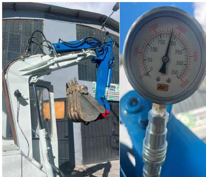
**Ilustración 4-4:** Presión cilindro de excavación retracción completa.
