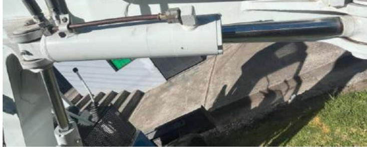
**Ilustración 3-12:** Cilindro de giro.
