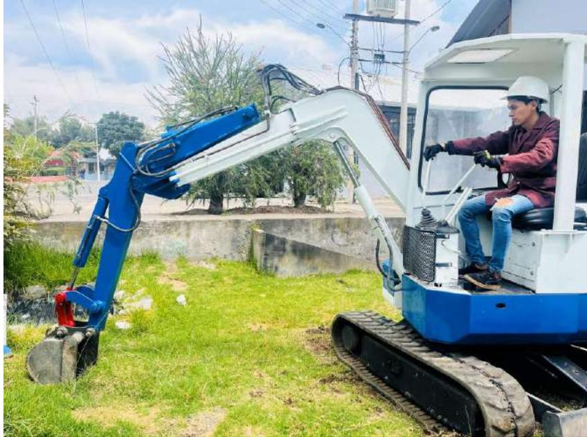
**Ilustración 3-26:** Pruebas de funcionamiento en condiciones de trabajo.
