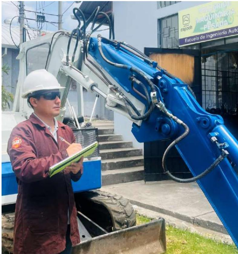
**Ilustración 4-6:** Medición caídas de presión de cilindro de excavación.
