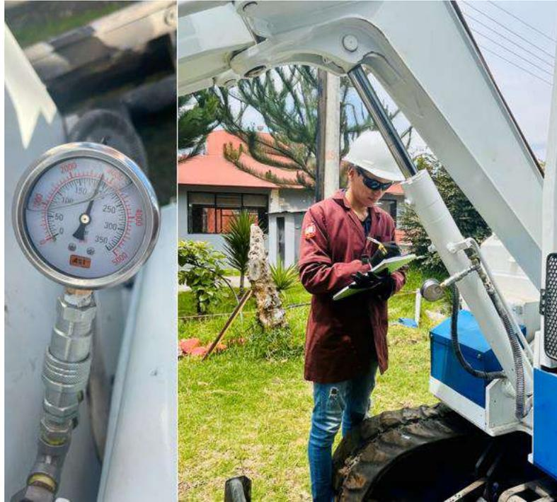
**Ilustración 4-5:** Medición caídas de presión de cilindro de elevación
