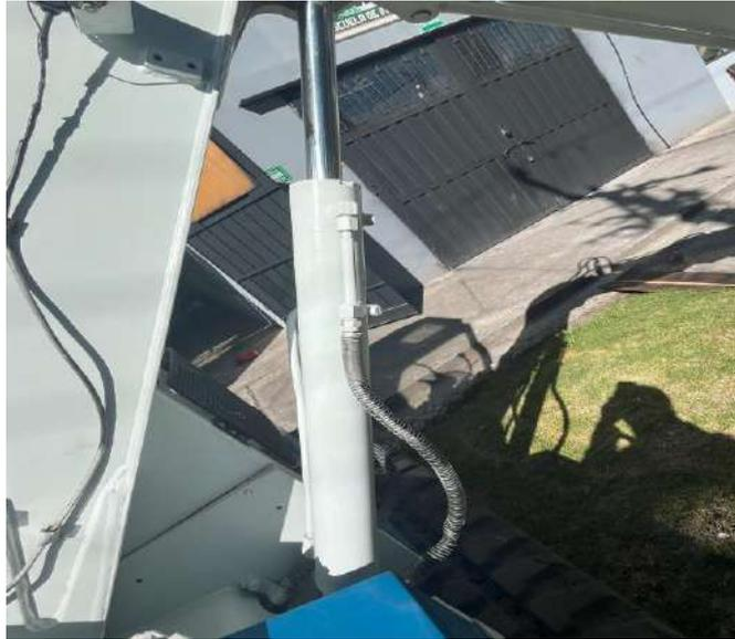
**Ilustración 3-8:** Cilindro de Elevación.
