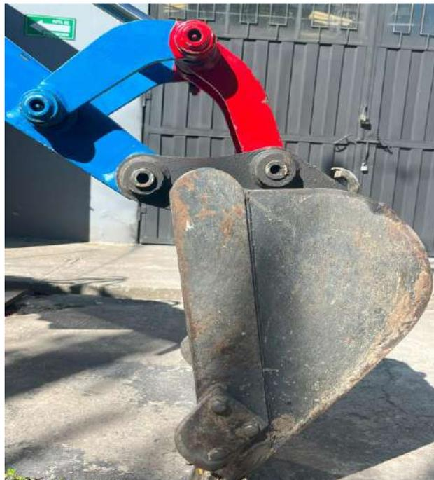
**Ilustración 3-11:** Cucharón de excavación.
