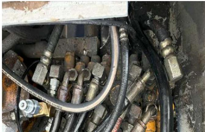
**Ilustración 3-13:** Válvula de control.
