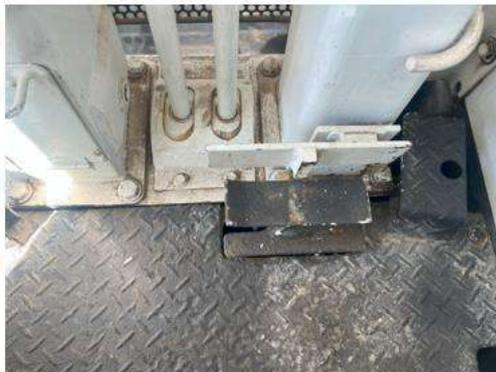
**Ilustración 1-1:** Pedal de giro horizontal del brazo
