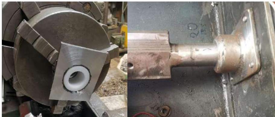
Ilustración 3-57: Chumaceras de pared con el bocín de nylon.
