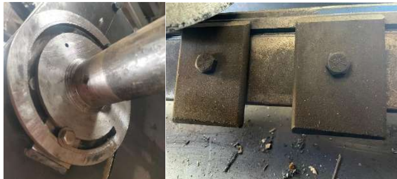
Ilustración 3-59: Placa circular de inclinación y mordazas de sujeción.
