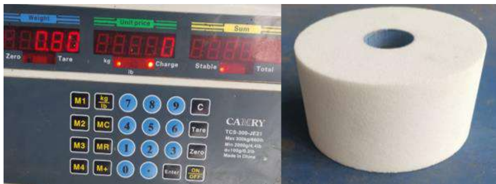
Ilustración 3-7: Peso de la piedra de afilar de copa forma 6.
