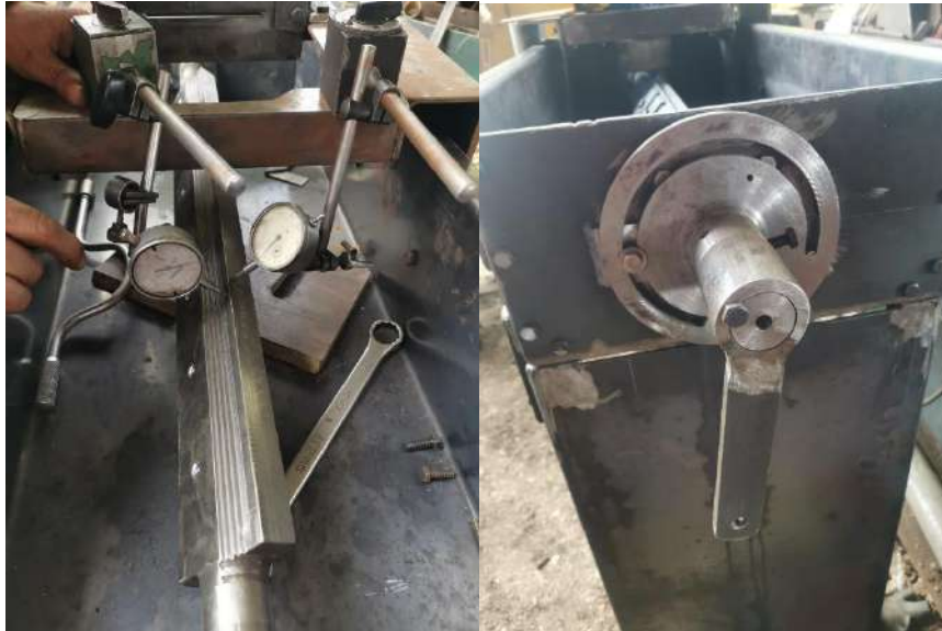
Ilustración 3-58: Calibración del sistema porta cuchillas y palanca de movimiento.
