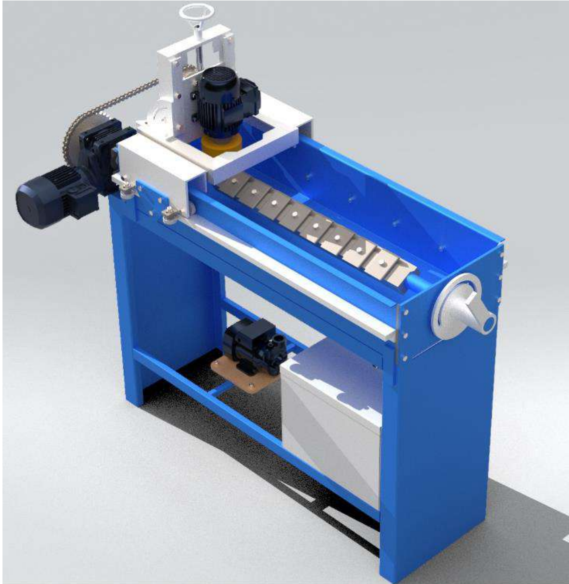
Ilustración 3-33: Diseño en SolidWorks de la maquina afilado – rectificado de cuchillas planas.
