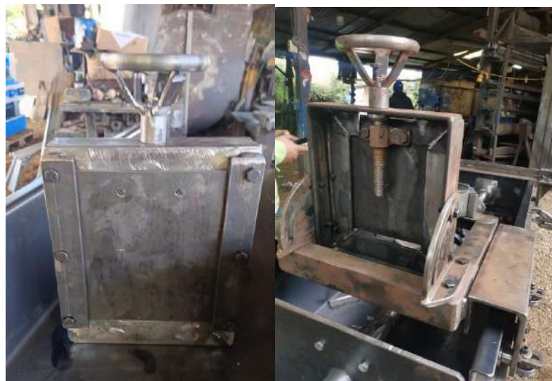
Ilustración 3-61: Cola de milano para un motor de 2 hp.
