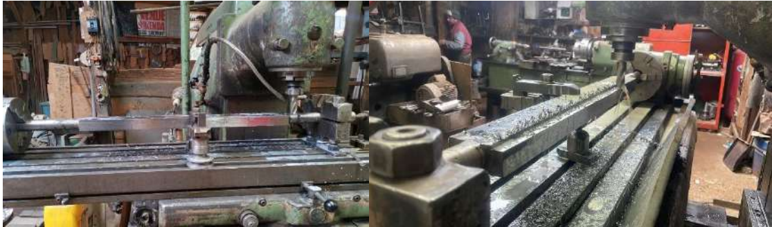
Ilustración 3-56: Rectificado de la mesa porta cuchillas en una fresadora
