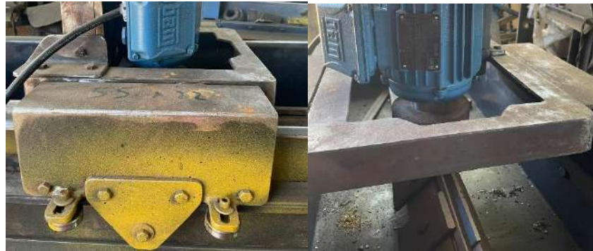
Ilustración 3-60: Ruedas y base rectangular del carro móvil.
