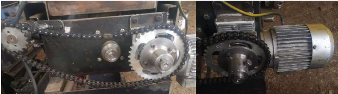
Ilustración 3-64: Sistema de avance lineal y motorreductor.
