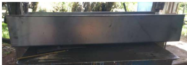
Ilustración 3-55: Estructura base mediante chapa metálica.
