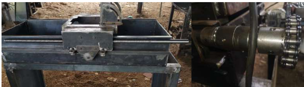
Ilustración 3-63: Tornillo de avance lineal y bocines de acople.
