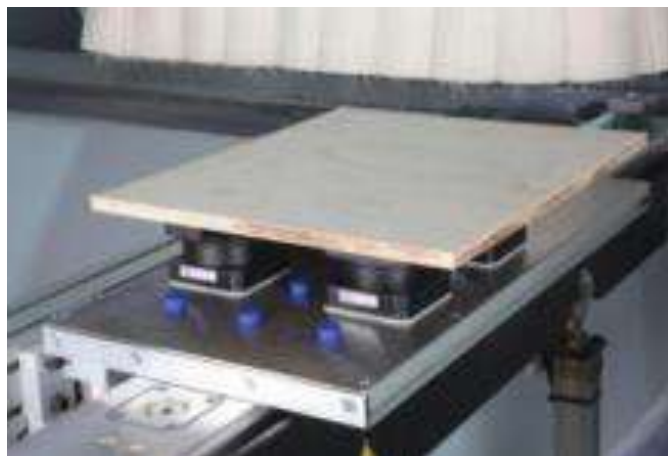
Ilustración 2-8: Fijación por Vacío.
