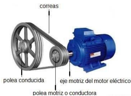
Ilustración 2- 13: Sistema de transmisión por poleas-correas
