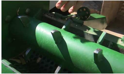
Ilustración 2- 11: Desgranador con platinas helicoidales
