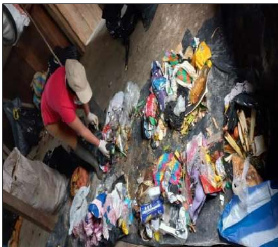
Aplicación del método de cuarteo
