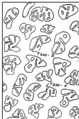
Ilustración 2-4: Esquema de una camada de cascarilla.
