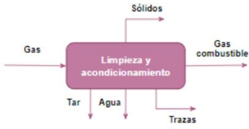
Ilustración 3-5: Diagrama del sistema de limpieza y acondicionamiento del gas
