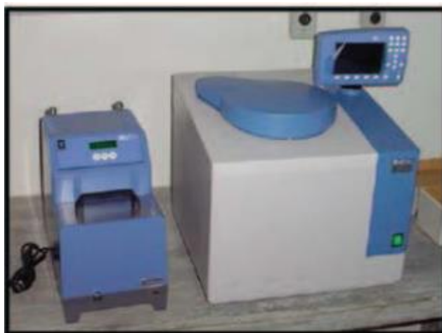
Ilustración 2-13: Bomba calorimétrica digital (Modelo C2000 Control, Ike Werke)
