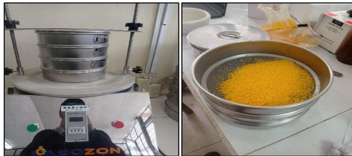
**Ilustración 3-14:** Tamizado de la yema de huevo deshidratada
