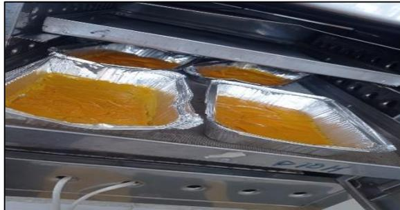
**Ilustración 3-12:** Ingreso de las yemas en el secador de bandejas a 70°C
