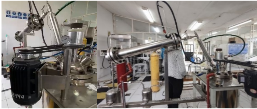
Ilustración 3-3: Sistema de agitación y disposición de las manguera
