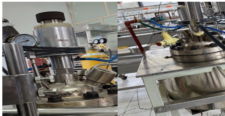
Ilustración 3-4: Manómetros del equipo y tapón de salida de aire
