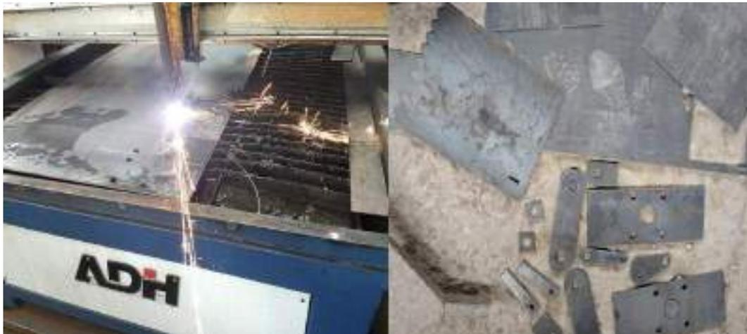
**Ilustración 4-12:** Proceso de corte en una cortadora plasma CNC.
