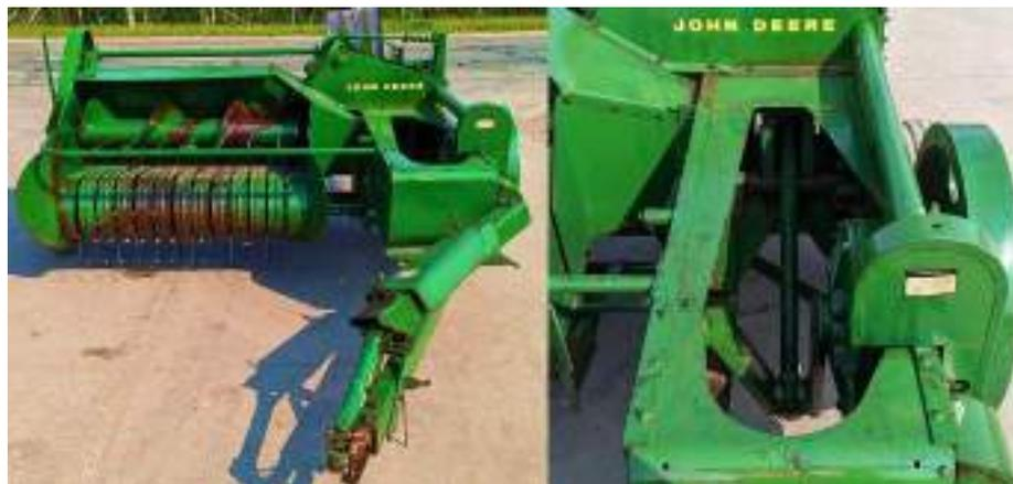
**Ilustración 2-11:** Empacadora John Deere 14T con prensa de biela manivela.
