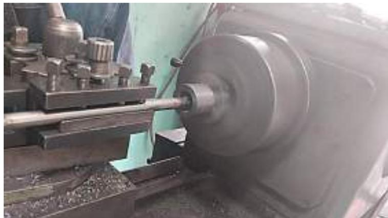
**Ilustración 4-14:** Proceso de torneado en las piezas cilíndricas de la enfardadora.
