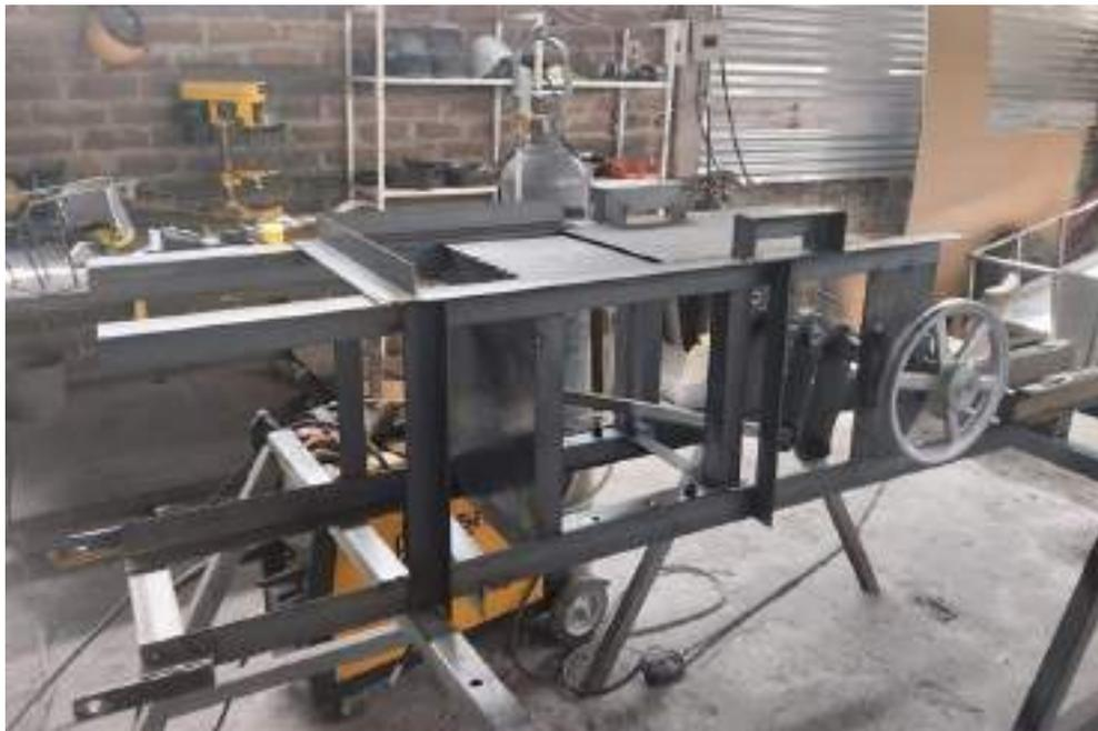
**Ilustración 4-15:** Proceso de soldadura GMAW en los componentes de la enfardadora.
