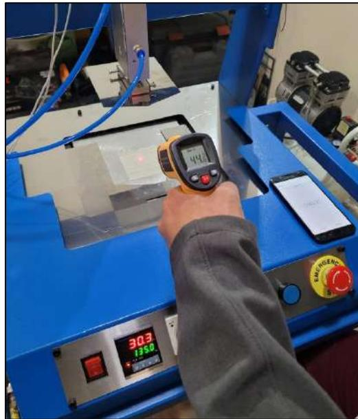
**Ilustración 4-1:** Toma de mediciones de la placa calefactora
