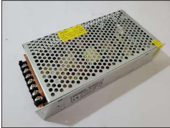
**Ilustración 3-44:** Fuente de poder de 24V a 120-240VAC
