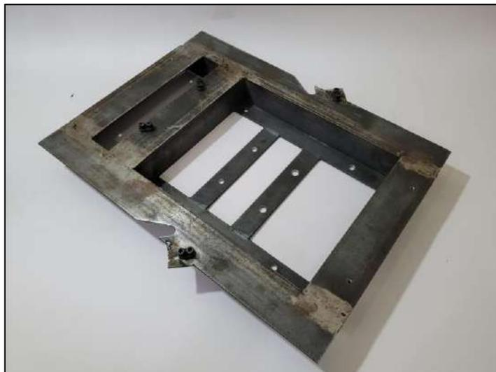
**Ilustración 3-52:** Estructura base del mecanismo de plegado
