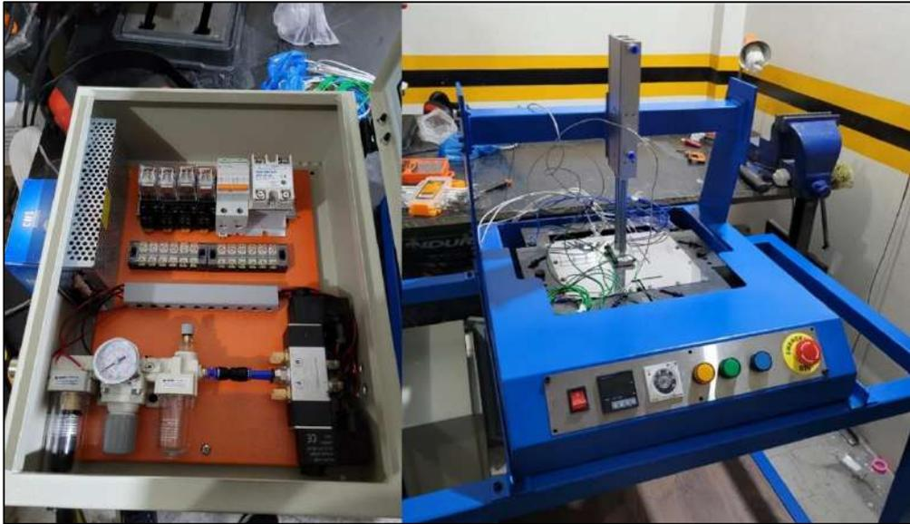
**Ilustración 3-61:** Caja de control y panel de mando de la máquina planchadora
