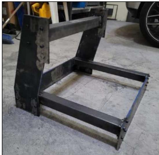
**Ilustración 3-50:** Estructura base de la máquina de planchado
