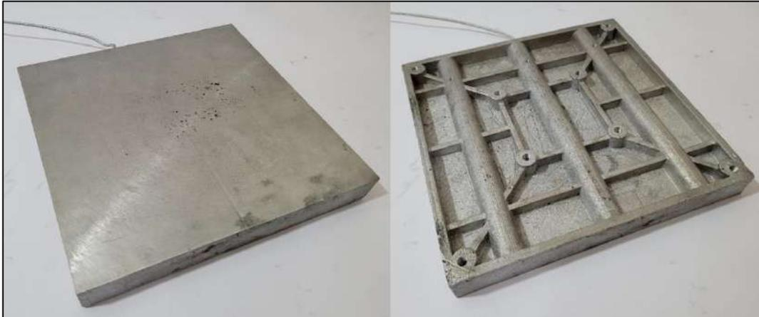
**Ilustración 3-51:** Placa calefactora de aluminio fundido mecanizada
