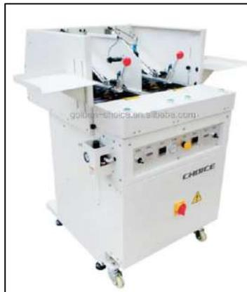
**Ilustración 2-7:** Planchadora de bolsillos automática
