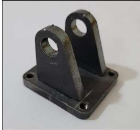
**Ilustración 3-59:** Bases de cilindros MAL25-25
