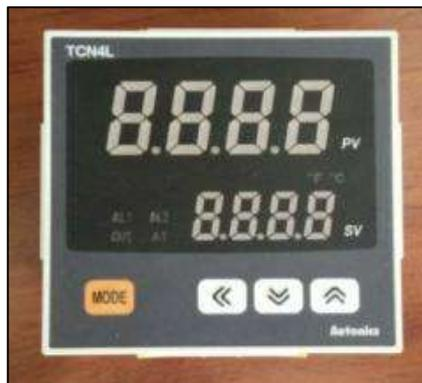
**Ilustración 2-13:** Controlador de temperatura
