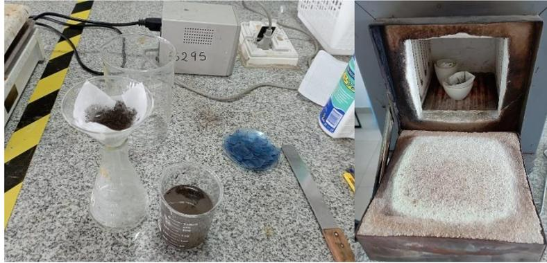
**Ilustración 3-7:** Proceso de extracción de plata de placas radiográficas
