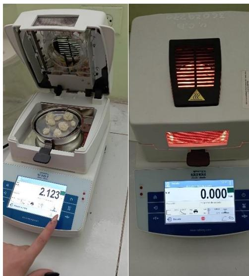
**Ilustración 3-4:** Determinación de humedad en Termobalanza
