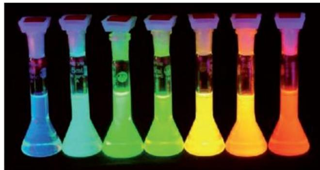
**Ilustración 2-6:** Soluciones de nanopartículas de CdSe a diferente tamaño
