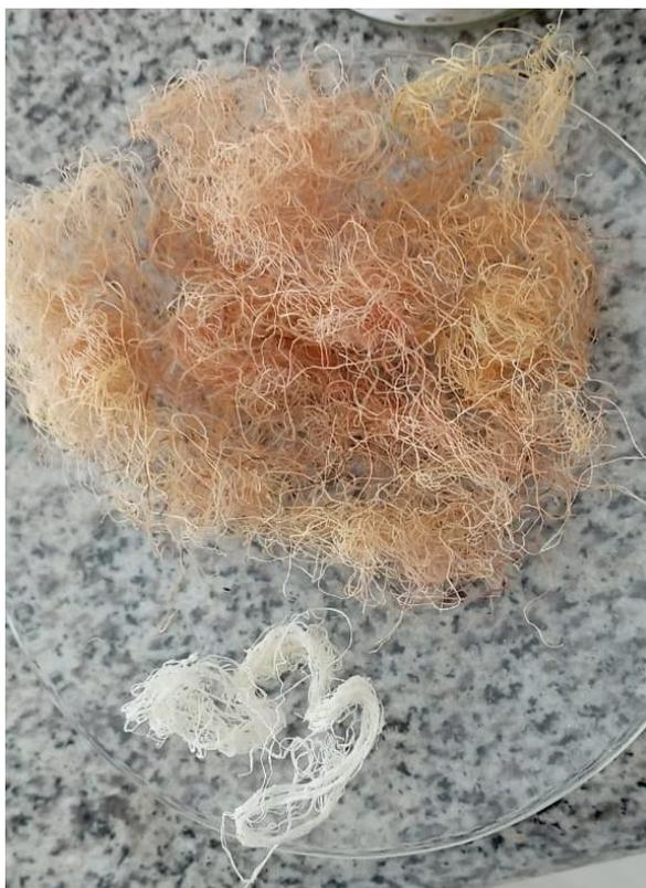
**Ilustración 4-6:** Comparación entre fibra hidrolizada e impregnada de nanopartículas de plata
